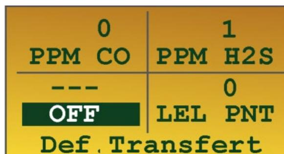
그림 23 : '폴트 전송' 상태를 보고하는 이차 BM 25W
